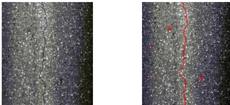
Figura 8. Imagine digitală achiziționată (stanga) și fisurile identificate (dreapta).
