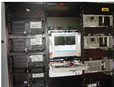
Figure 2. Sistemul de stocare a datelor dintr-un vehicul ARAN.
