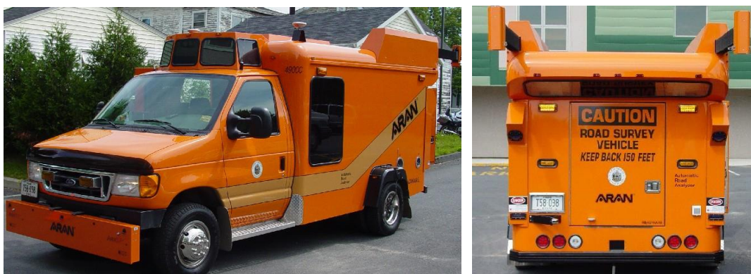
Figura 1. Vehicul ARAN multi-functional pentru achiziție date pavaj si carosabil.
