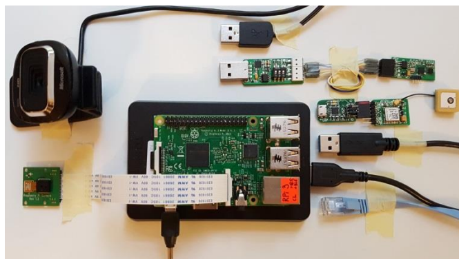
Figura 2.4: Componentele sistemului de achiziție, montate pe autoturism (din [8])
