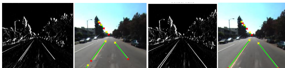
Figura 3.2. Extragere contururi si detectie drepte (Hough).
